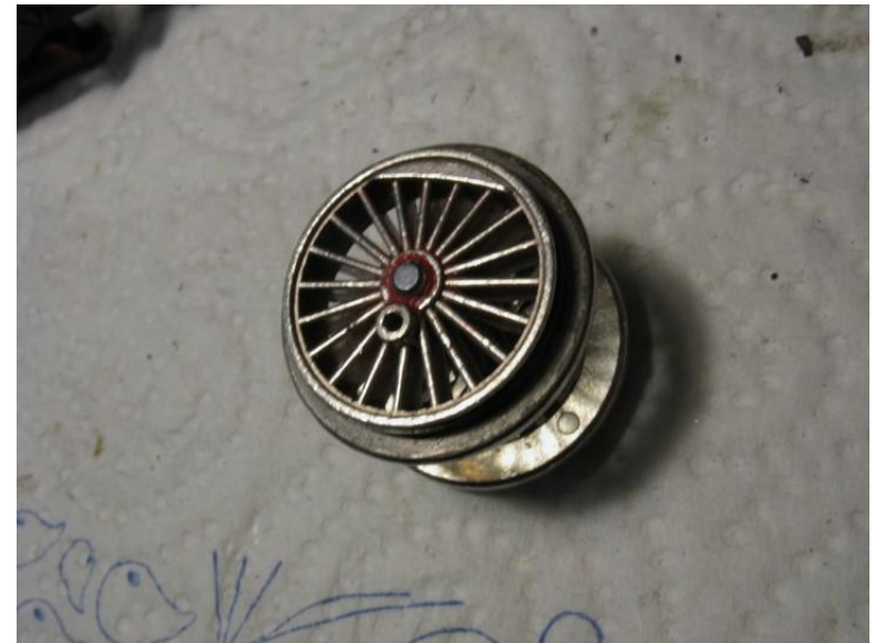
Nach dem Ultraschall zeigt sich die lausige Lackqualität von Trix: Die Räder der Treibachsen sind „blank“.
