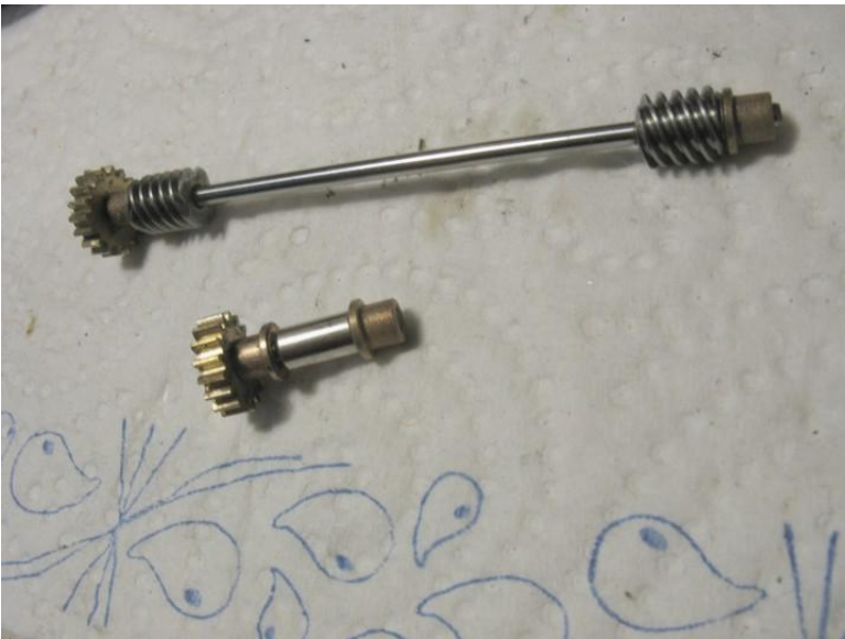
Nach dem Ultraschallbad sind die Getriebeteile von Schmutz und klebrigem Fett befreit
