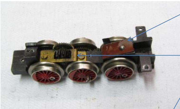
Diese Pappeinlage ist wichtig, damit die Motorschnecke nicht auf dem Schneckenrad klemmt. Wenn sie fehlt, ersetzen mit Papier 120 – 160 g/m<sup>2</sup>
