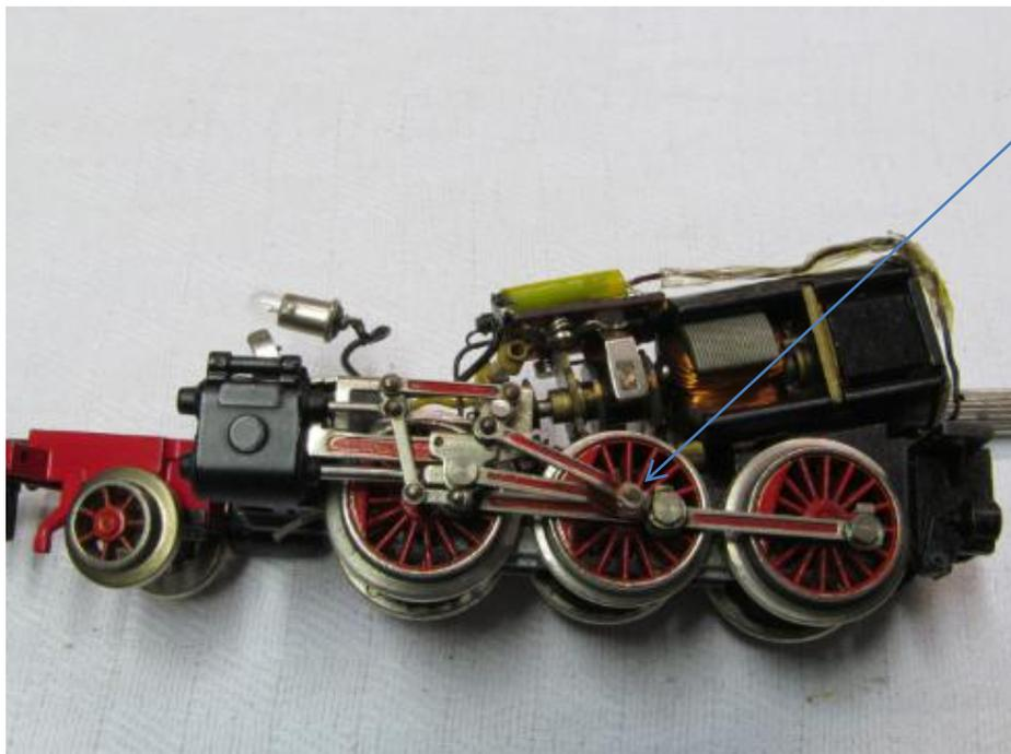
Liegt die Gegenkurbel mit ihrer Feder richtig in der Nut des Zapfens, ist sie fast exakt über die Achse ausgerichtet.
