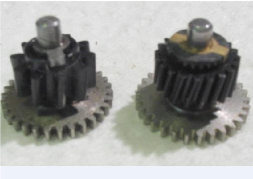
Hier einmal die beiden Zwischenwellen mit den unterschiedlichen Schneckenrädern – links Modul 0,8 – rechts Modul 0,4. Dementsprechend sind auch die Schnecken auf dem Motor deutlich zu unterscheiden. Die Übersetzung ist aber in beiden Fällen gleich. Diese beiden Formen der Schneckengetriebe finden sich bei allen „Schneckenloks“ BR24/64, BR80, V36/E63.
