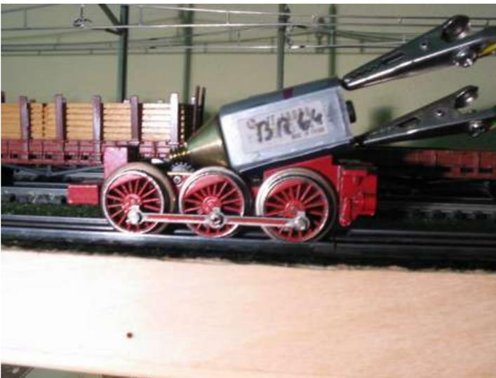
Die Kuppelstangen werden als nächstes angebracht, um prüfen zu können, daß die Lage der Räder korrekt ist. Klemmt es beim Probelauf, muß die abweichende Achse um einen Zahn weiter gestellt werden. Wenn man Pech hat, war vorher schon ein Rad auf der Achse verdreht. Dann muß das korrigiert werden. Zur Not das Rad mit einem Abzieher von der Welle holen und in der richtigen Lage wieder aufpressen. Sich gegenüber liegende Räder sind um 90 Grad versetzt.
