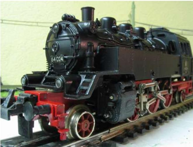
Für die Lackierung beize ich die alte Farbe ab. Die feinen Ritzen werden dann mit einer Messingbürste auf der Minibohrmaschine und einem Zahnstocher gereinigt. Vor der Lackierung wird mit Waschbenzin entfettet.
