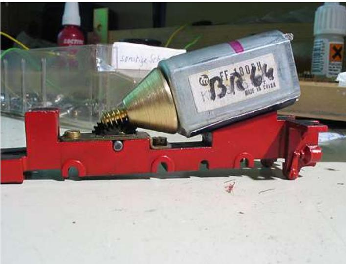
Zuerst also wird der Motor eingebaut. Hier ist es ein Mabuchi mit Schwungmasse. Die Schnecke darf nicht auf dem Zahnrad klemmen und muß auf beiden Enden über dieses hinaus ragen. Liegt der Schneckenein- oder ausgang auf dem Zahnrad, gibt es erhöhten Verschleiß und häßliche Geräusche
