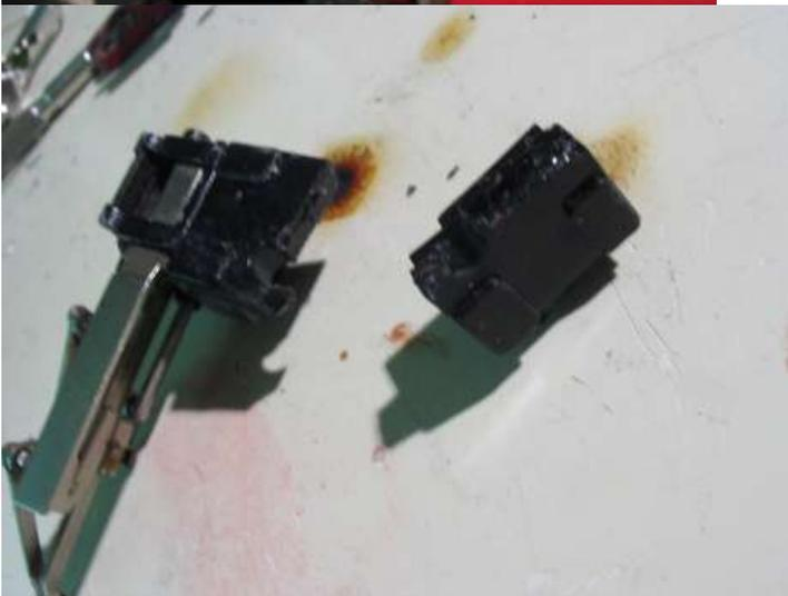
Die Zylinder kann man vom Block herunter schieben. Der Gestängehalter (Kreuzkopflaufbahn) ist durch den Zylinder geschoben und vorn umgebogen. Biegt man das auf, kann man das ganze aus dem Zylinder ziehen. So kann man die Zylinder besser lackieren
