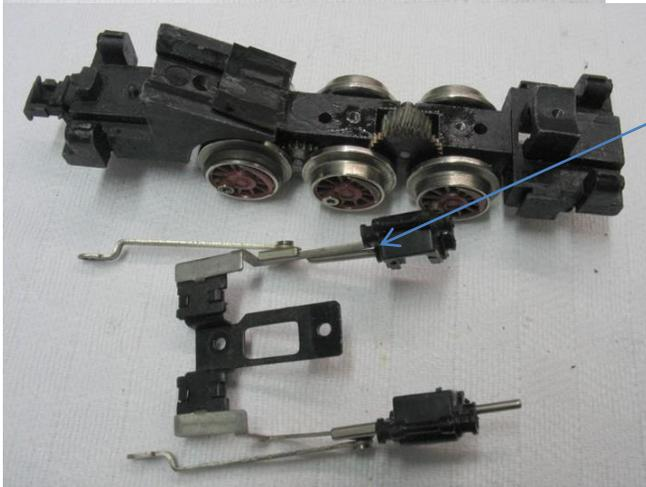
Jetzt sind Zylinder, Gleitbahnen und Schneckenwellenhalterung als ein Teil abgehoben. Normalerweise braucht man das nicht weiter auseinander zu nehmen. Sollte es wegen Beschädigung nötig sein: Es ist nur zusammengesteckt.
