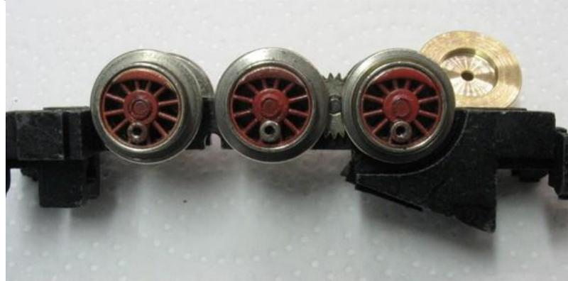
Mit den beiden Senkkopfschrauben nimmt man die Achslagerplatte ab. Alles wird gereinigt und frisch gefettet.
