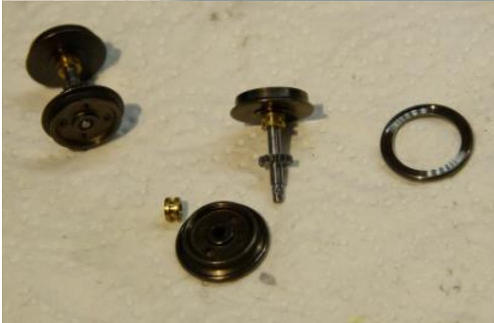
Die Räder erhalten ihre Spurkranzringe. Abgezogen werden die Räder mit den Isolierbuchsen. Sie lassen sich sicherer wieder aufpressen. Bei der Montage hinterher darauf achten, daß auch bei der mittleren Achse das isolierte Rad auf der gleichen Seite sitzt, wie bei den äußeren Achsen.
