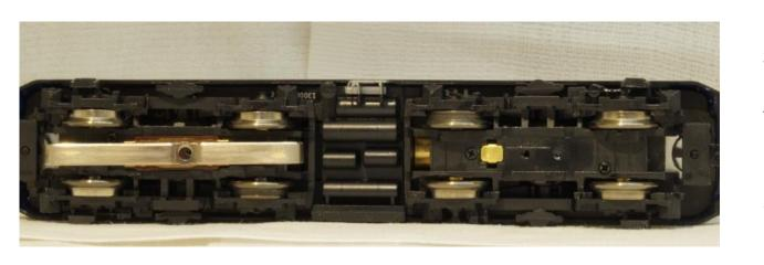
So sieht die fertige Lok von unten aus. Der lange Skischleifer paßt perfekt in die Aussparungen des Drehgestellbodens. Deshalb habe ich ihn den Löffelschleifern vorgezogen. Für die Zugkraft ist es am sinnvollsten, die Haftreifenachsen zur Lokmitte hin zu plazieren
