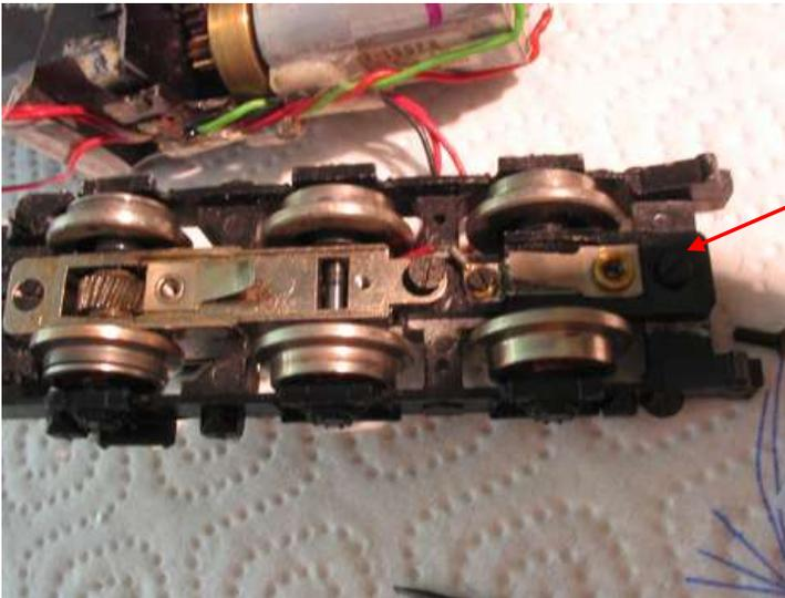
Die Achsabdeckung ist geteilt. Die innere Achse wird mit einer Kunststoffplatte abgedeckt. Das ist nötig, damit der Außenschleifer keinen Massekontakt bekommt.
