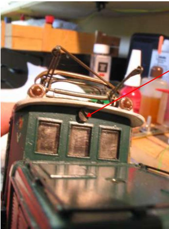
Will Man das Dach separat lösen, finden sich diese Schrauben an beiden Stirnseiten unter dem Dach.
