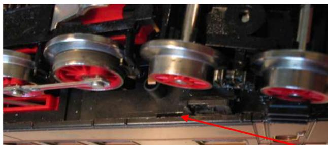
Um das Gehäuse zu öffnen, muß man es an der Unterseite spreizen.
