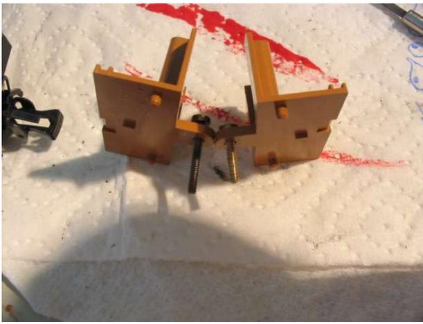
Die beiden Schrauben der Führerstandsverkleidungen sind nicht identisch! Die kürzere gehört über das zweiachsige Laufgestell.
