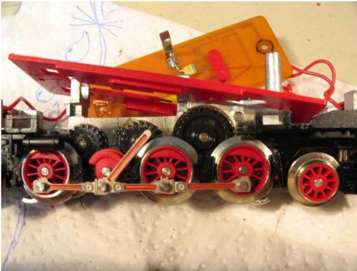
Ist der Motor draußen, kann man auch die rote Radschleiferplatte abnehmen. Die Radkontakte reinigen, ebenso die Flächen der Räder (Waschbenzin). Jetzt kann man auch gut **etwas** Fett auf die einzelnen Zahnkränze geben und die Lager **leicht** ölen. (gaaaanz sparsam)
