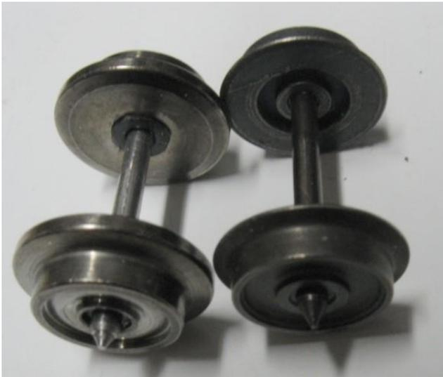
Man sollte sich immer bemühen, daß der Durchmesser der Lauffläche gleich bleibt. Sonst hängt die Kupplung tiefer, als bei anderen Wagen. Nur wenn es gar nicht anders geht, kann man auf kleinere Räder zurückgreifen. Bei neueren Wagen wird man fast ausschließlich die abgebildeten Spitzenlager finden. Zapfenlager gibt es kaum bei anderen Herstellern.
