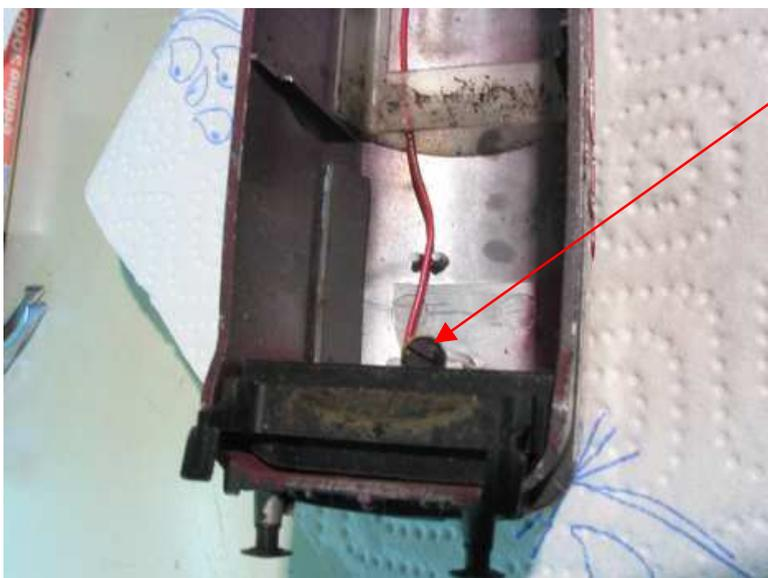
Löst man diese Schraube, kann man die Abschirmplatte mit den Rangiertritten, den Lampensockel und das Prisma heraus heben.
