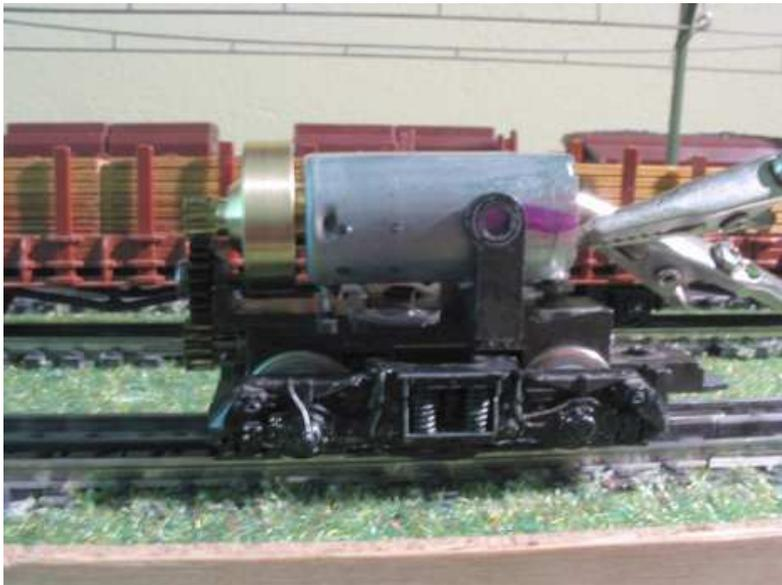
Noch bevor die Kabel angelötet werden, empfiehlt sich ein Probelauf mit Hilfe etwas längerer Kabel an Krokodilklemmen
