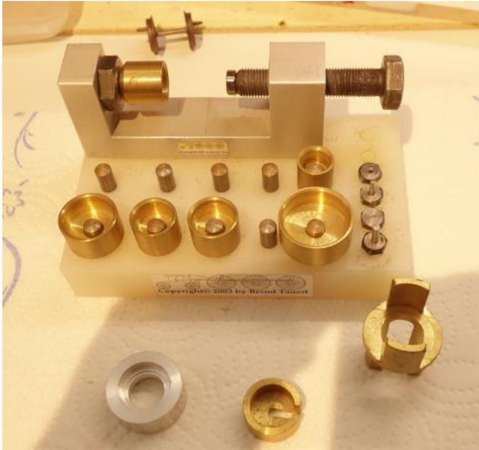
Solch eine Aufpressvorrichtung für Radsätze habe ich teuer gekauft, aber brauche sie fast nie. Für Lokradsätze tut es der Schraubstock. Radsätze für Wagen, für die man die Vorrichtung braucht, bearbeite ich kaum, sondern tausche sie aus
