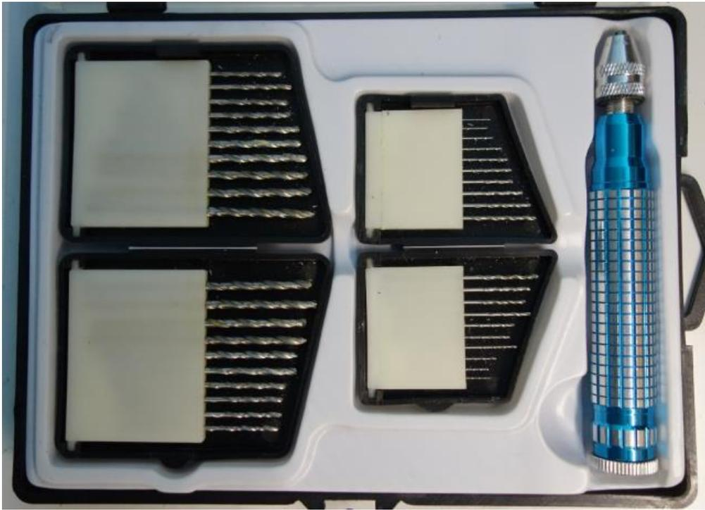
Stiftenklöbchen mit Bohrern in der Stufung 0,1 mm
