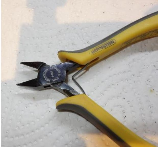
Ein Seitenschneider für weiche Drähte und Kabel. Mit guten Exemplaren kann man Papier schneiden (zur Probe geschlossen gegen Licht halten)
