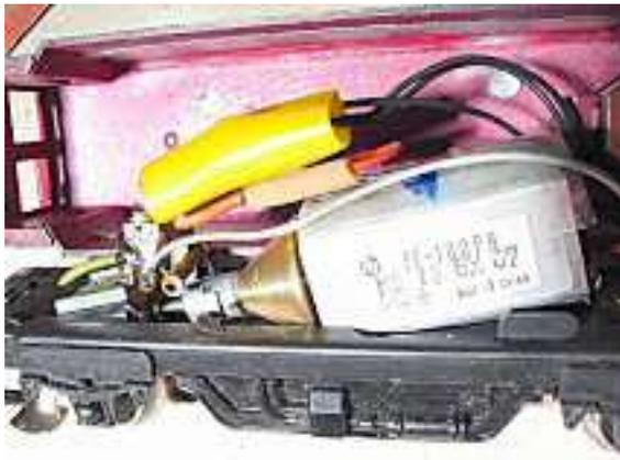
Hier ist der neue Motor eingeklebt (auf dem Bild noch mit der alten, konischen Schwungmasse- inzwischen verbessert).
