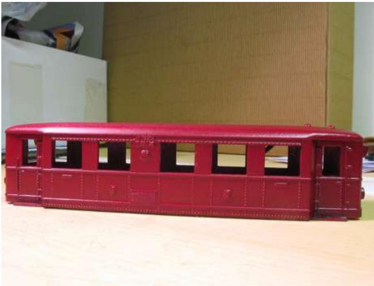
Zur Lackierung wird die alte Farbe abbeizt. Mit einer kleinen Messingdrahtbürste und einer Minibohrmaschine werden die Reste aus den Ritzen entfernt.
