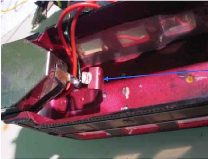
Die Kabel des Beleuchtungskastens werden am Untergestell abgelötet (mit Gleichrichter)
