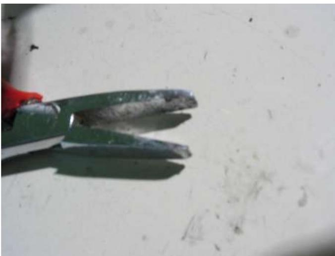
Dieses kleine Werkzeug, eine Flachzange mit glatten Backen, verwendet man, um Blechnasen gerade zu biegen. Da sie nicht geriffelt ist, kann man damit auch sehr gut verbogene Trittbleche gerade biegen.
